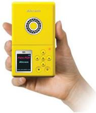
**PalmTron** оборудование для экстракции нуклеиновых кислот
